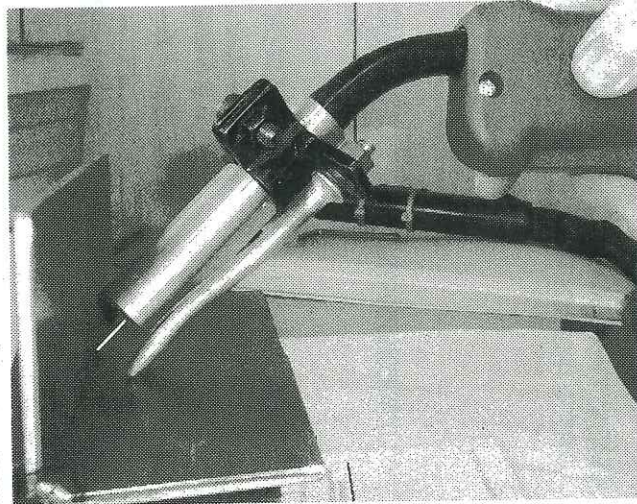
トーチに付けた工具が支えになり溶接を補助する
