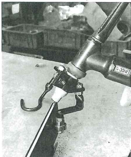
TIG溶接用で、SUSの薄板溶接等の 角継手すみ肉溶接に適した 「スーパーコーナーガイド」
