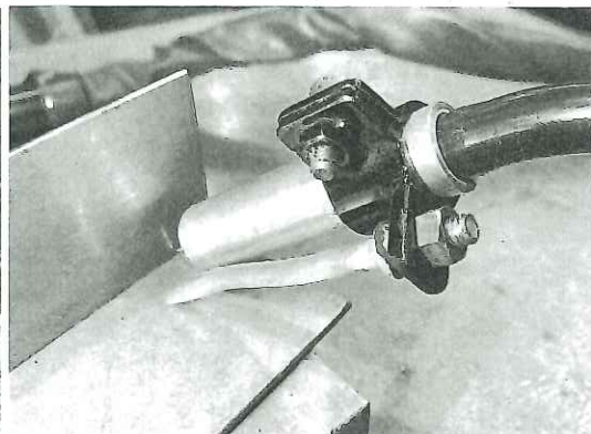
手ブレなしで、溶接作業の効率化を図る CO 2 ・MAG溶接用水平すみ肉溶接に最適な 「ステックスミガイド」
